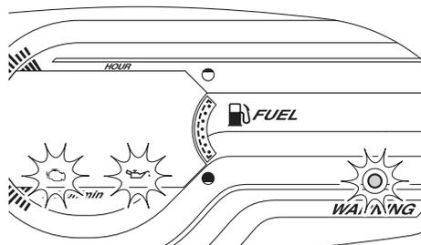
Si la alarma de la presión de aceite se activa, reduzca de inmediato la velocidad del motor, vuelva a tierra y compruebe el nivel de aceite del motor. (Consulte en la página 44 la información relativa a la comprobación del nivel de aceite del motor). Si el nivel de aceite es suficiente, revise la moto de agua en un concesionario Yamaha.
