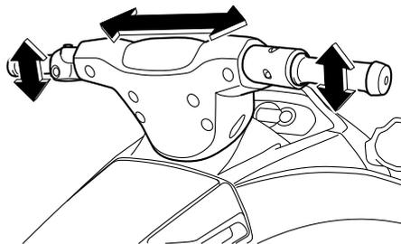
Gírelo todo lo que pueda hacia la izquierda y hacia la derecha para verificar que la tobera de propulsión se mueve a medida que gira el manillar, y que no hay diferencia entre las po-
