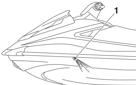
1 Surtidor testigo del agua de refrigeración
