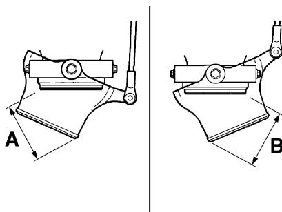
Diferencia entre las posiciones de completamente cerrada de la tobera de propulsión (distancias A y B):
