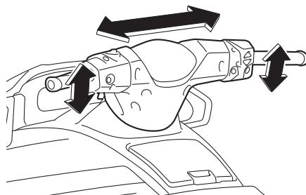
Gírela todo lo que pueda hacia la izquierda y hacia la derecha para verificar que la tobera de propulsión se mueve a medida que gira el manillar, y que no hay diferencia entre los po-
