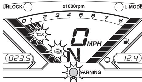
Si la alarma de la presión de aceite se activa, reduzca de inmediato la velocidad del motor, vuelva a tierra y compruebe el nivel de aceite del motor. (Consulte en la página 55 la información relativa a la comprobación del nivel de aceite del motor). Si el nivel de aceite es suficiente, revise la moto de agua en un concesionario Yamaha.
