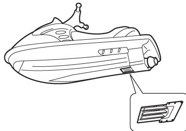
Si la toma de admisión del chorro o el rotor se obstruyen con algas o residuos, puede producirse cavitación y el empuje disminuirá aunque aumente el régimen del motor. Si se prolonga esta situación, el motor se recalienta y puede averiarse. **ATENCIÓN: Si penetran algas o residuos en la toma de admisión del chorro, navegue al ralentí hasta que los haya eliminado.** [SCJ00654]
