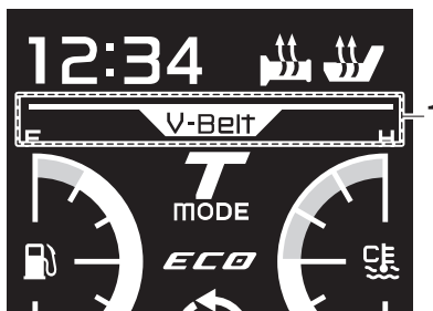
1. Indicatore di sostituzione cinghia trapezoidale "V-Belt"
