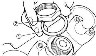
10. Después de apretar la tuerca compruebe si la dirección se mueve con suavidad. Si no es así, ajuste la dirección aflojando la tuerca anular poco a poco.
