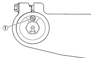
**AJUSTE DE LA AMORTIGUACIÓN EN EXTENSIÓN DE LA HORQUILLA DELANTERA**
