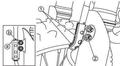
4. Pase el tubo de freno a través de las guías delanteras del tubo de freno "1".
