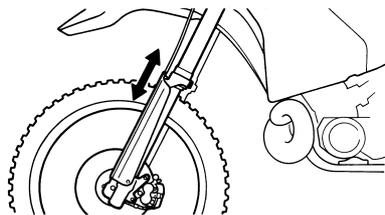
**LIMPIEZA DE LA JUNTA DE ACEITE Y LA JUNTA ANTIPOLVO DE LA HORQUILLA DELANTERA**
