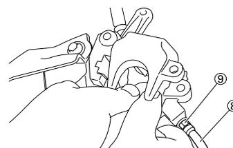
f. Afloje el tornillo de purga y empuje hacia adentro el pistón de la pinza.
