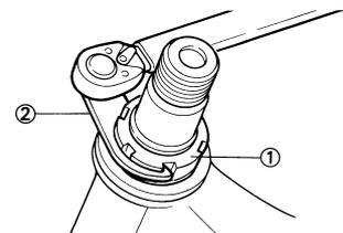
5. Compruebe el vástago de la dirección girándolo completamente de lado a lado. Si se atasca, desmonte el conjunto del vástago de la dirección y revise los cojinetes.
