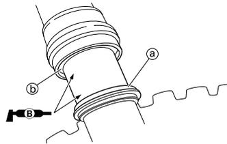
**DESCARGA DE LA PRESIÓN INTERNA DE LA HORQUILLA DELANTERA**
