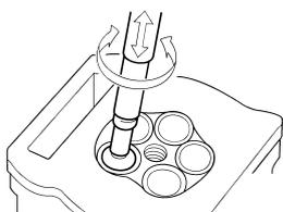
e. Aplique un compuesto lapidador fino al frontal de la válvula y repita las operaciones anteriores.
